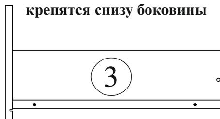
ЛДВП прибивается, после прикручивания шариковых направляющих
